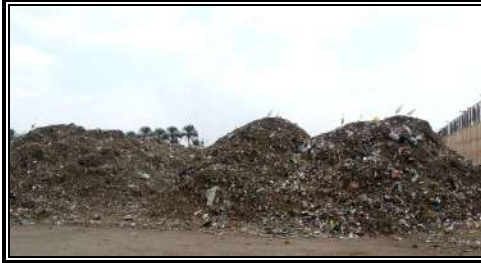
صورة (2-3) السماد الأولي ومصفوفته المعدة بعد تحللها للدخول إلى منخل السماد النهائي (الناعم)
