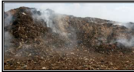
صورة (6-7) مرفوضات فرز السماد الناعم مشتعلة ذاتياً وعمليات نقلها إلى المردم الصحي
