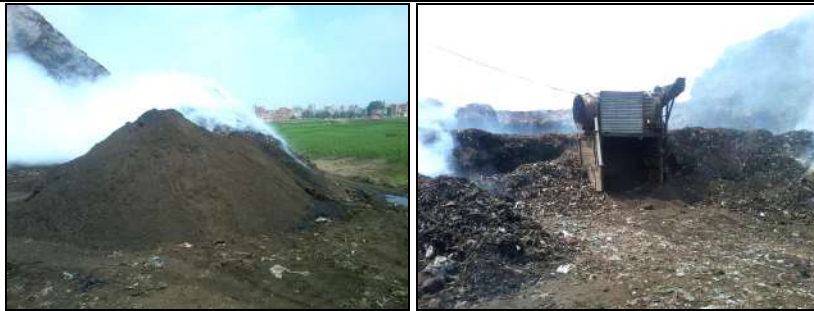
صورة (٣-١) نخل المخلفات واستخراج السماد العضوي (المكب العمومي بمدينة شبين الكوم)
