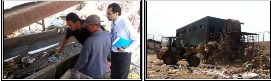
صورة (٣-٢) رفع القمامة وإدخالها إلى وحدة الفرز عبر السببر الناقل
