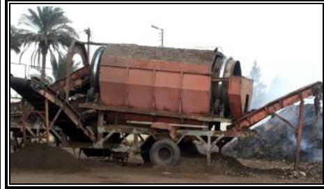
صورة (4-5) وحدة فرز السماد الناعم والسماد الناتج عنها
